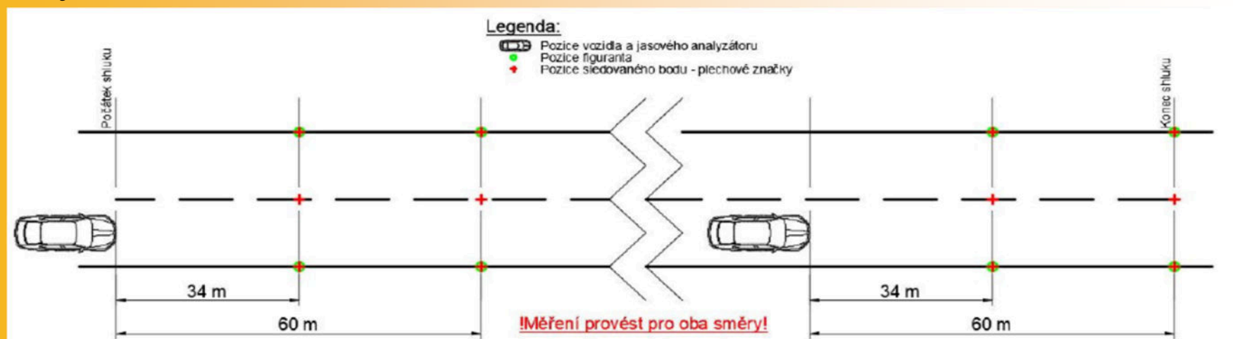
Obr.17 Pozice pozorovatele a směr pohledu v jízdním pruhu na hodnocené body prostoru úseku komunikace
