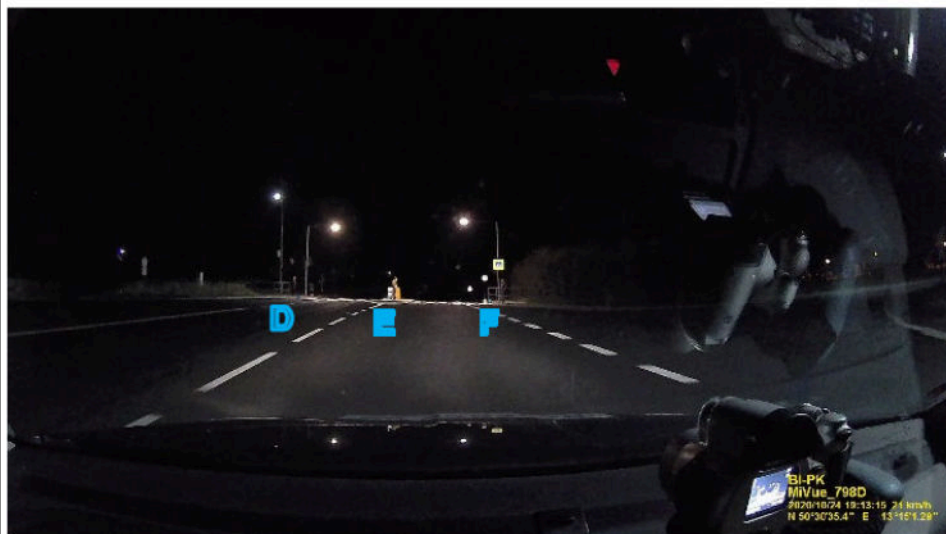
Tlumený režim reflektorů OA typ H7
